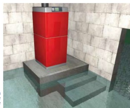
Protection d'un équipement de chauffage par surélévation.
